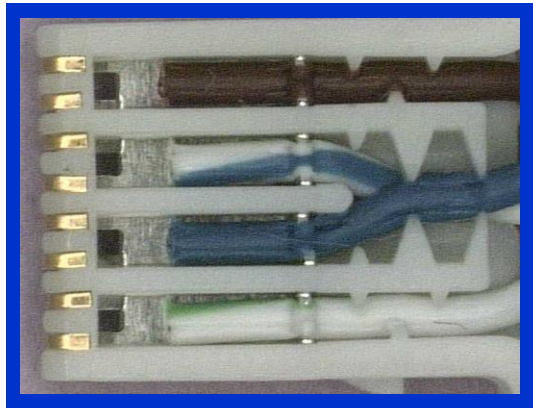
Résistance de contact avec fil souple de 0,14 mm 2
